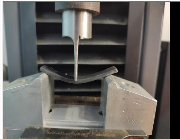
**Determinación del módulo de resistencia de las resinas acrílicas con óxido de grafeno empleadas.**
