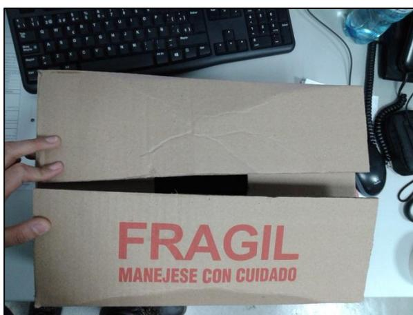
*Figura 15.* Pruebas de cajas, presentan defecto de descuadre de solapas
