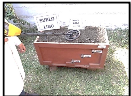
IMAGEN 16: Realizando la búsqueda de indicio conductor cartucho, a 20 cm de profundidad, en suelo limo, con el uso del detector de metal Garrett ACE 250.
