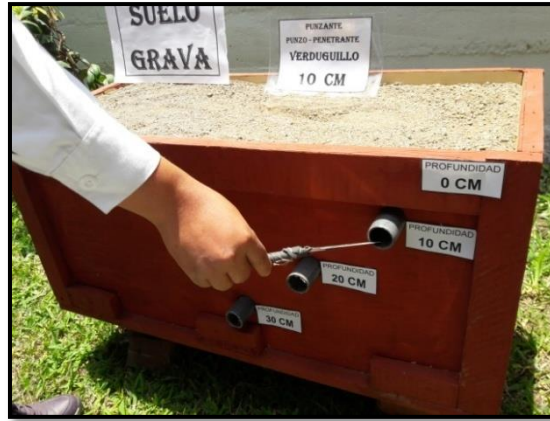
Figura 11. Caja hecha de madera con tubos de plástico que sirven para colocar las muestras.
