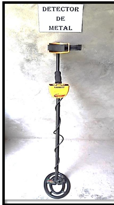
IMAGEN 01: Detector de metal Garrett ACE 250, equipo que nos ayudó a buscar indicios conductores (metales) en los diferentes tipos de suelos.
