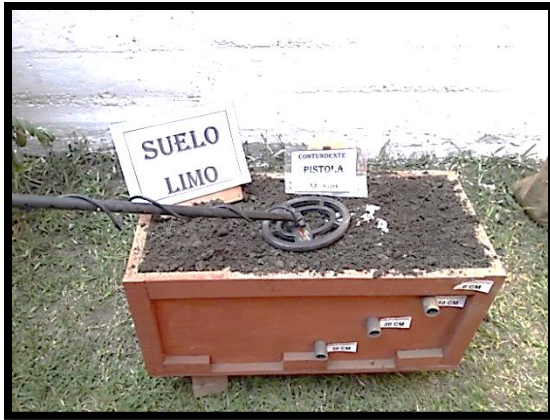
IMAGEN 15: Realizando la búsqueda de indicio conductor punzocortante cuchillo, a 10 cm de profundidad, en suelo limo, con el uso del detector de metal Garrett ACE 250.
