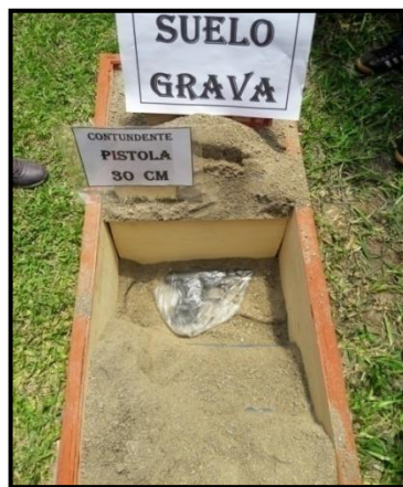
Figura 12. Pistola enterrada a 30 cm de profundidad.
