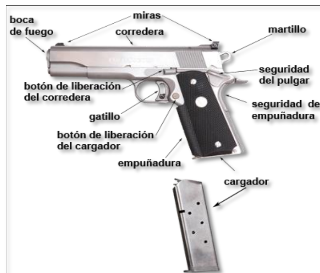
Figura 10. Partes de una pistola
