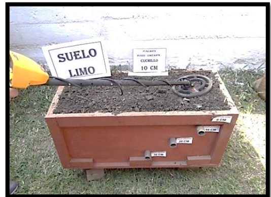
IMAGEN 14: Realizando la búsqueda de indicio conductor contundente pistola, a 0 cm de profundidad, en suelo limo, con el uso del detector de metal Garrett ACE 250.
