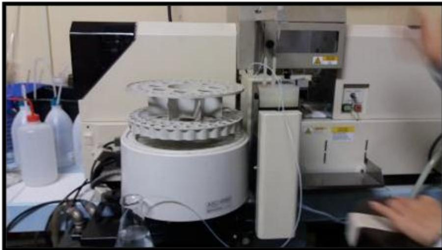
FOTO N° 7: Equipo de Espectrofotómetro de Absorción Atómica SHIMADZU AA-6800.
