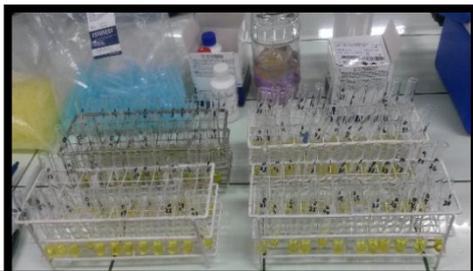
Fig. 12. Luego de retirar del BM se añade el reactivo color para determinar AST, se deja 20' a T° amb. Después añadir NaOH v dejar 15' a T° amb.
