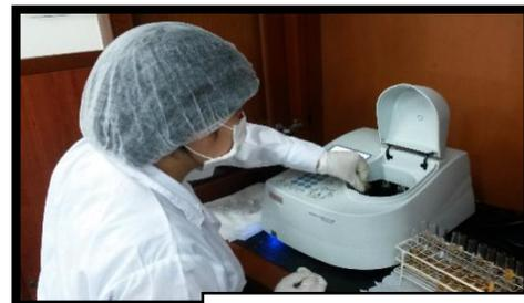
Fig. 15. Lectura de la Abs frente a un blanco de agua en el espectrofotómetro a 505 nm.
