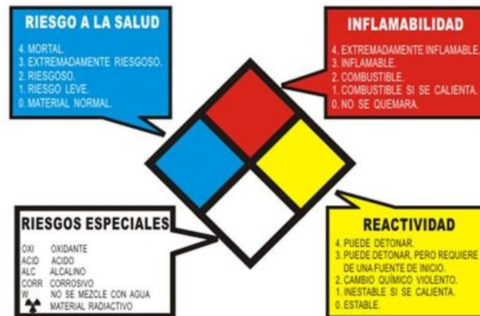
Figura 11. Identificación de riesgos por sustancias químicas. Fuente: Industrialesinnovando.com (2016)
