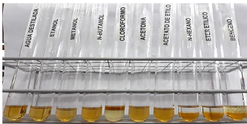
Figura 1. Prueba de solubilidad del extracto hidroalcohólico de las hojas de Rumex cuneifolius Campd. “Romaza”.
