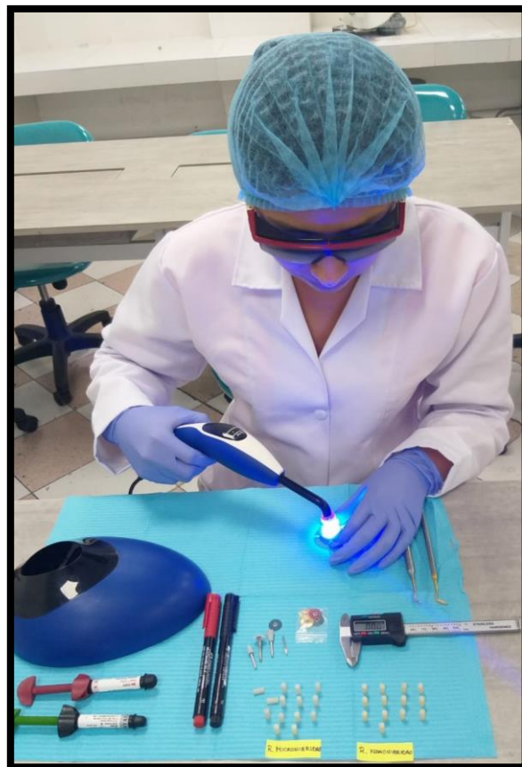
Fotocurado de 20 segundos a 800 nw por cada incremento
