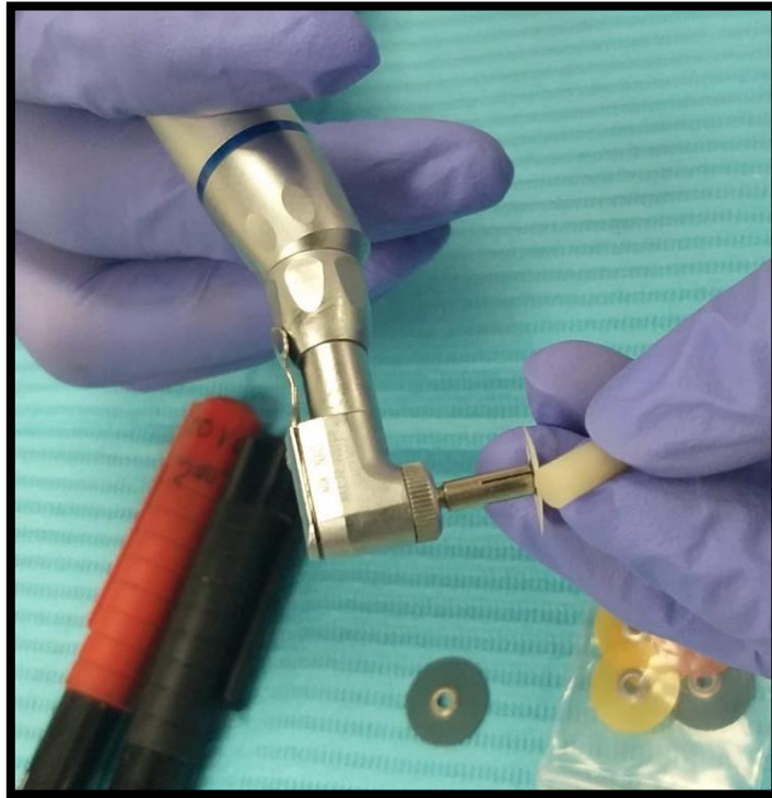
Pulido de los cilindros de resina con disco soflex ultrafino
