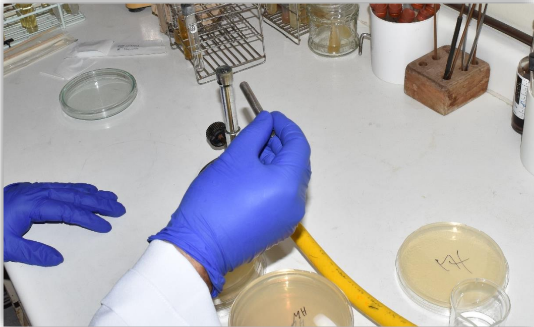
Fotografía 5: Calentamiento del sacabocado para realizar las perforaciones en el agar.
