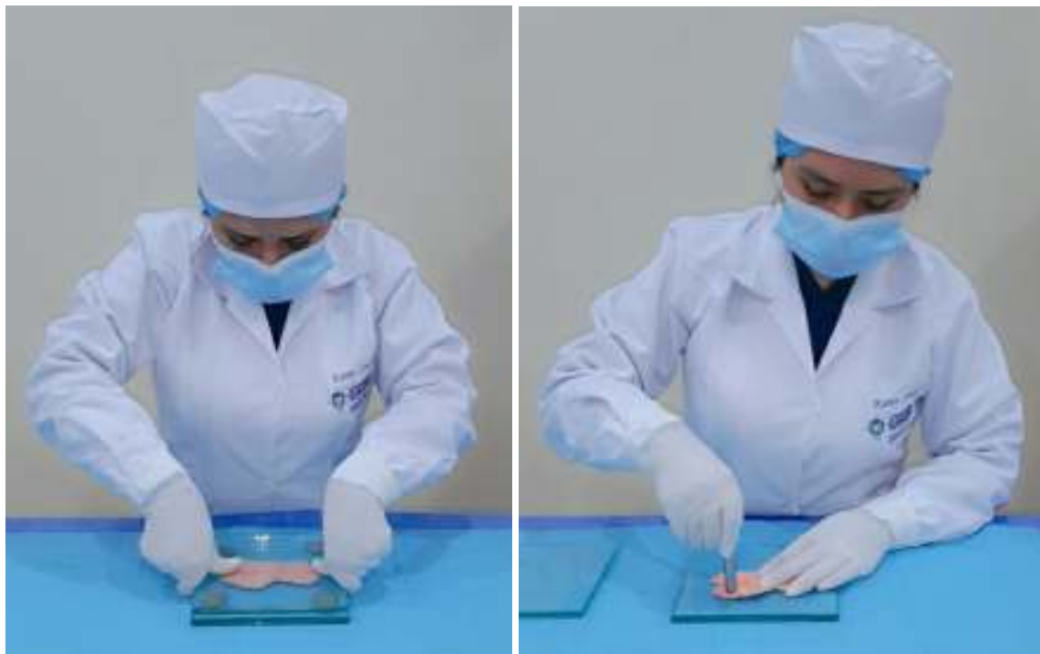
Lámina de gutapercha de 2 mm de grosor / sacabocado de 8 mm de diámetro
