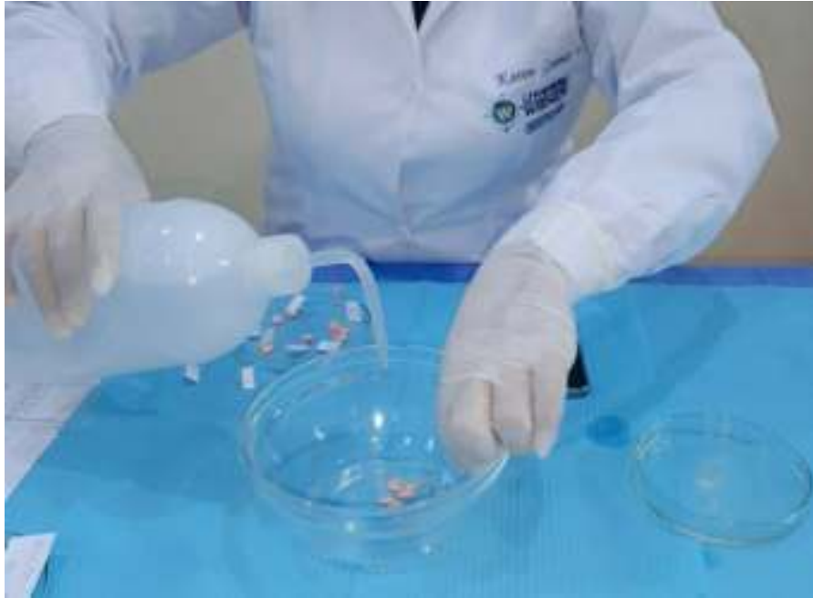
Enjuague de los discos de gutapercha con agua destilada antes de ser pesados
