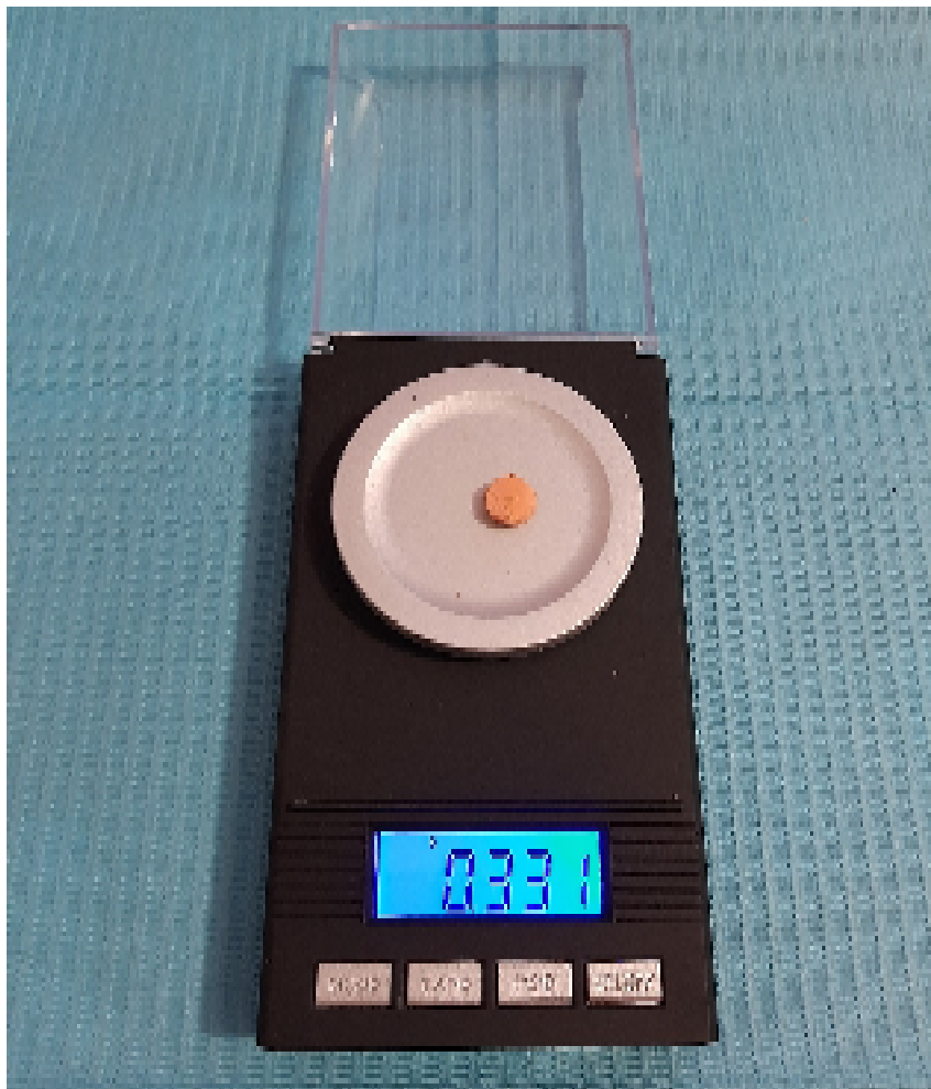
Peso de los discos de gutapercha luego de ser retirados de las sustancias solventes
