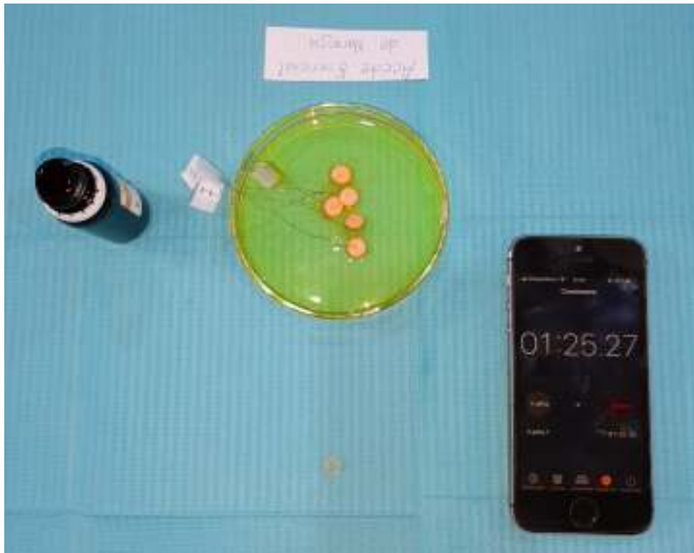
Discos de gutapercha sumergidos en las sustancias solventes
