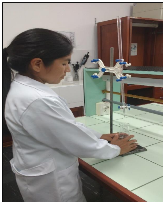
Figura 10. Titulación de ácido hipúrico por fenolftaleína
