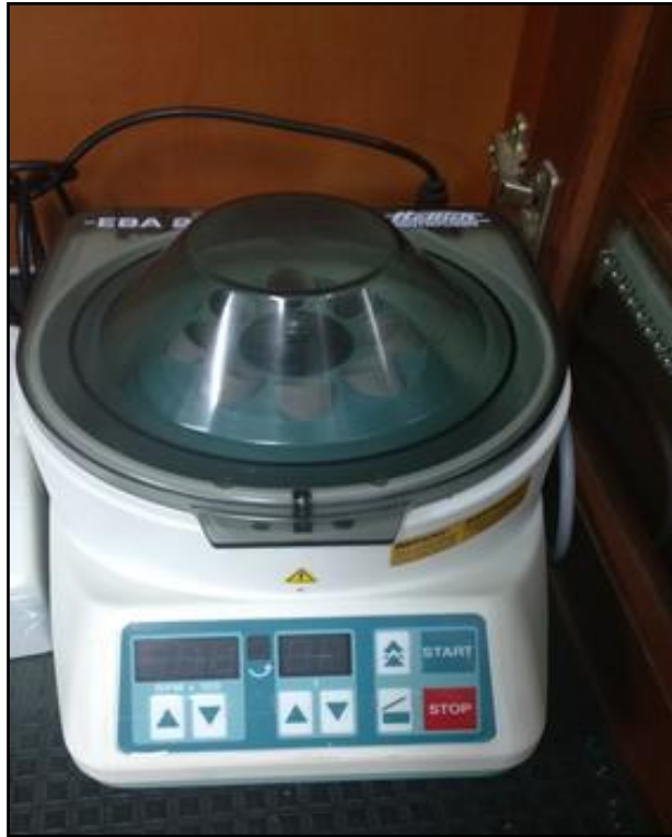
Figura 13. Centrifugación y obtención del sobrenadante Fuente: elaboración propia
