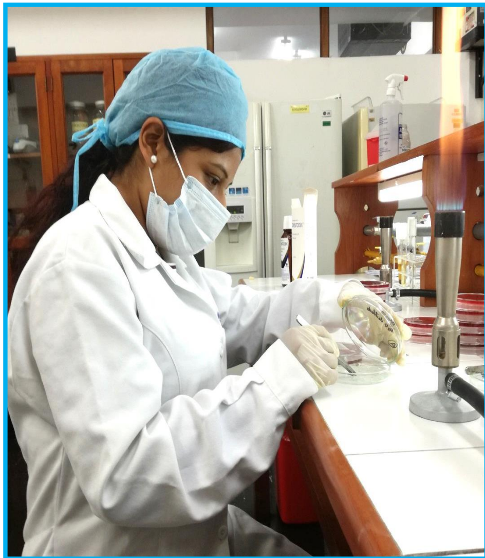
Figura 17. Proceso de inoculación de discos de papel filtro embebidos de la sustancia de estudio en placas petri.
