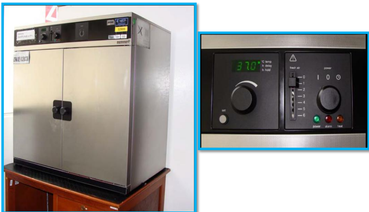
Figura 22. Estufa esterilizadora a calor seco circulación natural de aire, modelo 5NE40, marca Memmert - Alemania
