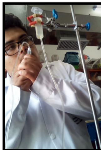
Figura 12. Calibración de plestismometro.
