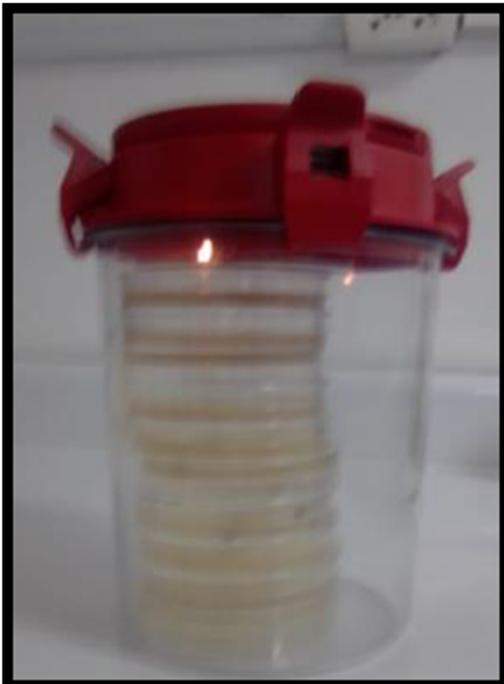
Jarra de anaerobiosis: Se observa la generación de CO<sub>2</sub>, por combustión de una vela para generar anaerobiosis en el ambiente interno de la jarra.
