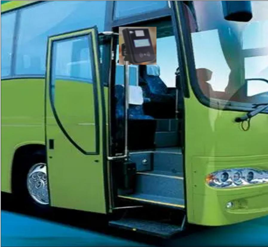
Figura 15 El escáner térmico en la puerta del bus.
