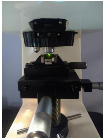
Foto 14: Indentación de una muestra del grupo salbutamol observada al microscopio a los 7 días.
