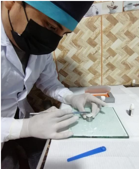
Figura 5 (Colocación de cemento MTA en la matriz)
