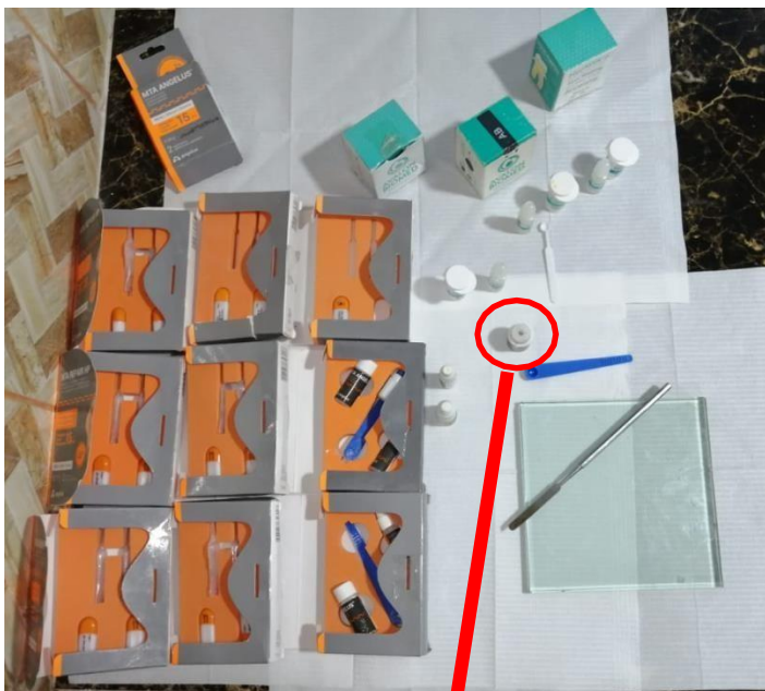
Figura 2 (Matriz para la elaboración de espécimen 6mm*4mm)
