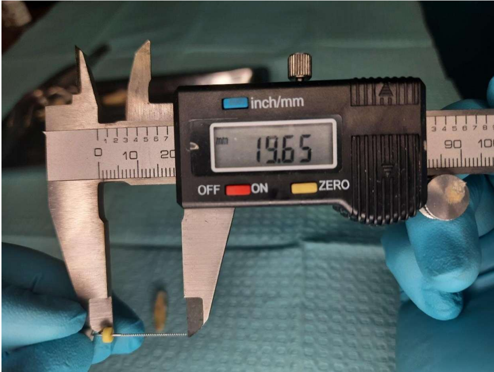
Empleo de calibrador vernier para medir la longitud de trabajo determinada por la lima endodóntica
