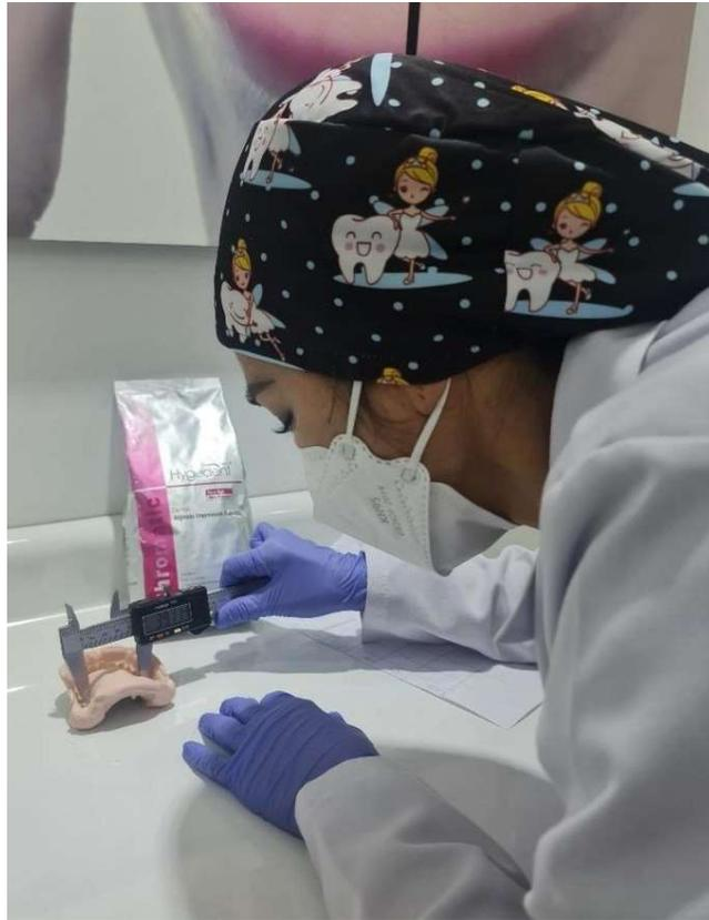
**Empleo de calibrador vernier digital para la medición de la distancia intermolar**
