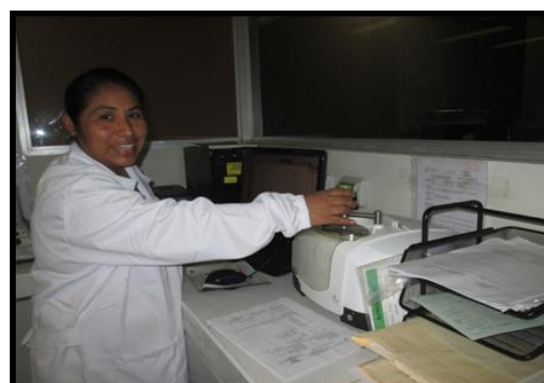
Figura N° 50: Análisis cualitativo en espectroscopia IR en el extracto de acetona y acetato de etilo del zumo de Punica granatum L. «granada»
