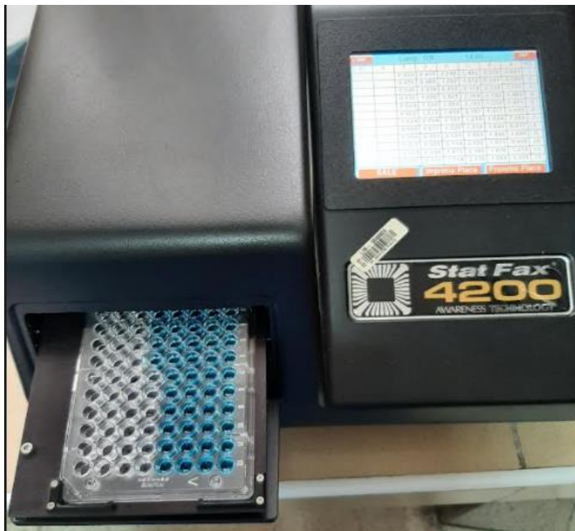
Figura 12 Equipo Lector de Elisa, para la detección cuantitativa de la hCG en las manchas sangre de mujeres embarazadas.
