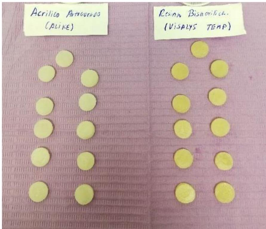
Discos conformados, izquierda discos de resina acrílica Alike color B1 (código 1), lado derecho discos de resina bis-acrílica color A1 (código 2).
