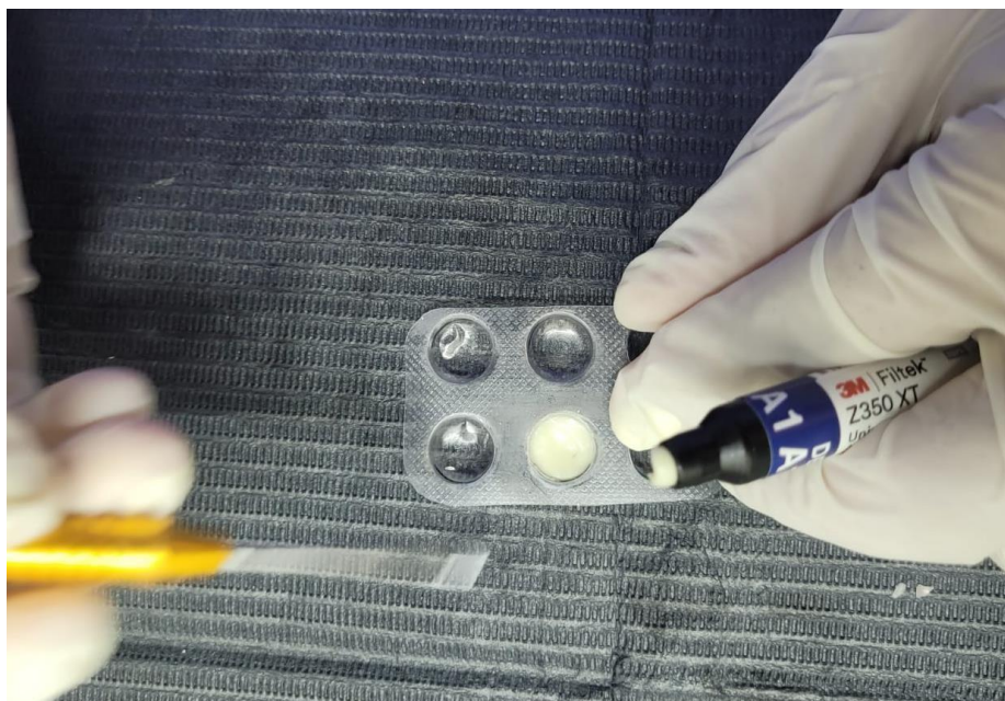
Formación de los discos de resina
