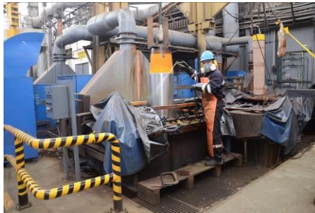
Figura 18. Proceso de cromado de la empresa JMS. Fuente: Empresa JMS
