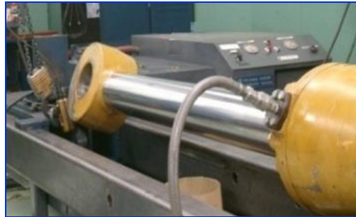
Figura 22. Proceso de prueba hidráulica. Fuente: Metalmecánica JMS
