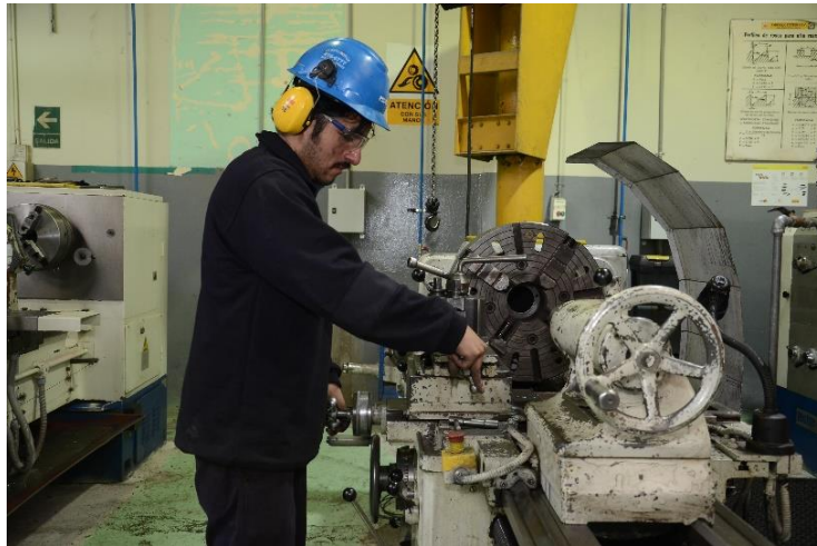
Figura 50. Foto de técnico de maquinado fabricando tapa principal de cilindro levante.
