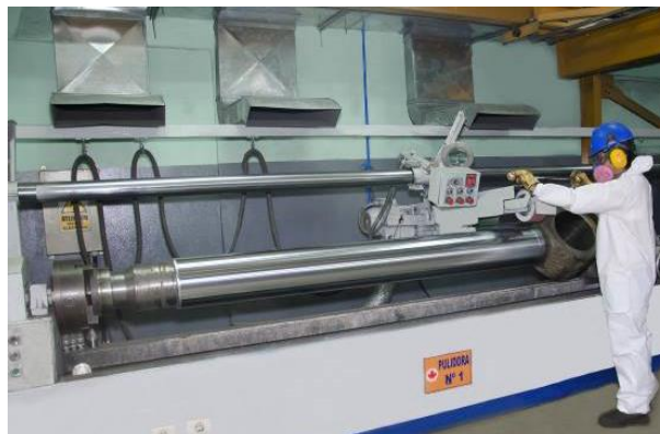
Figura 21. Proceso de pulido. Fuente: Metalmecánica JMS
