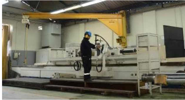
Figura 20. Proceso de rectificado. Fuente: Empresa JMS
