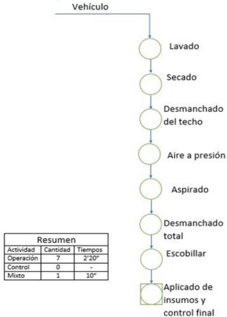
Figura 14. Diagrama de operaciones del proceso de lavado de salón. Fuente: Elaboración propia.
