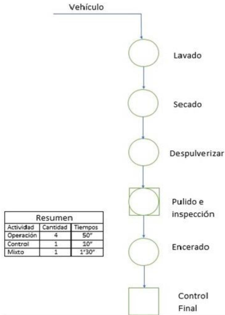
Figura 16. Diagrama de operaciones del proceso de tratamiento de pintura. Fuente: Elaboración propia.
