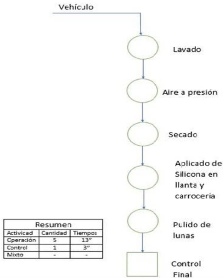
Figura 12. Diagrama de operaciones del proceso de lavado básico. Fuente: Elaboración propia.
