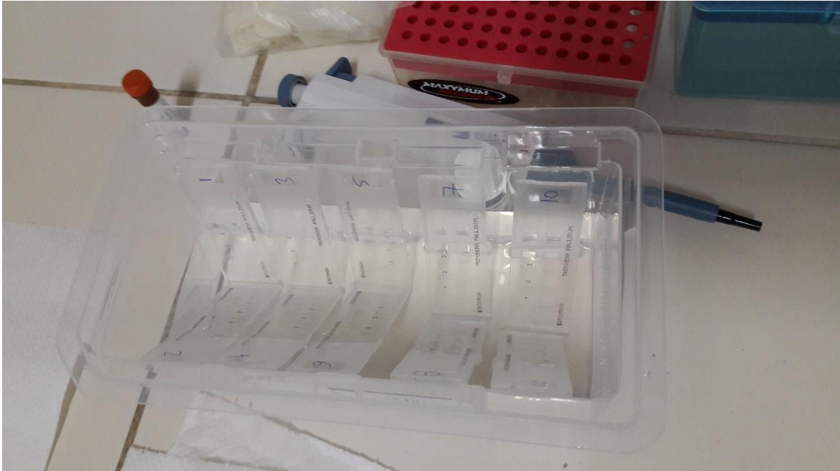
IMAGEN N°4 lavado de los BIOCHIPS slides con PBS-Tween.
