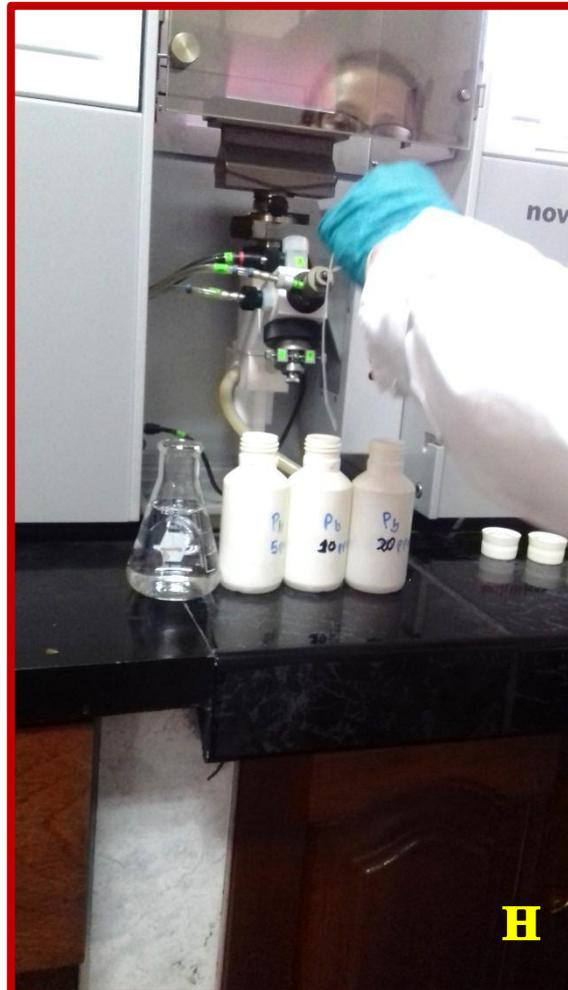
**G:** Equipo de Absorción atómica Analytik Jena AG NovAA 300 s/n BU3150169 con horno de grafito. **H:** Medición de los estándares por espectrofotometría de absorción atómica
