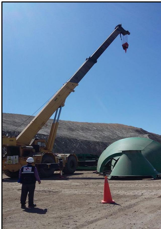
Figura 16. Grúa móvil telescópica.
