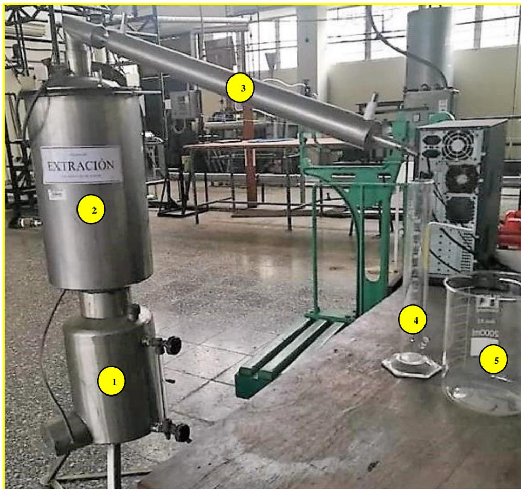
**Figura 4.** Equipo destilador por arrastre de vapor, cortesía del Ing. Pedro Romero y Otiniano – UNMSM
