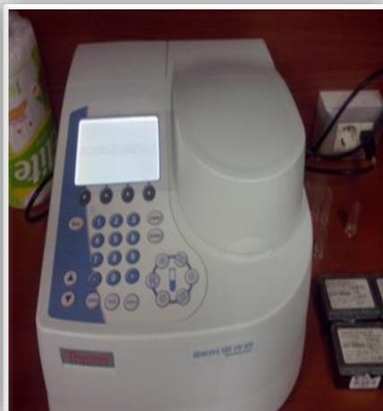
**Anexo 5.** Medición de la absorbancia en el espectrofotómetro marca Thermo Scientific Genesys.
