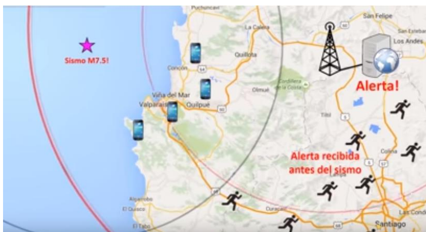
Figura 223. Flujo de emisión de la alerta sísmica.
