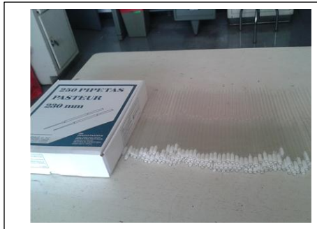
Preparación de pipeta pasteur con algodón, listó para la esterilización.
