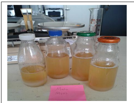
Medio en frascos listo para el autoclavado a 121° C, 15 libras, por 15 minutos.
