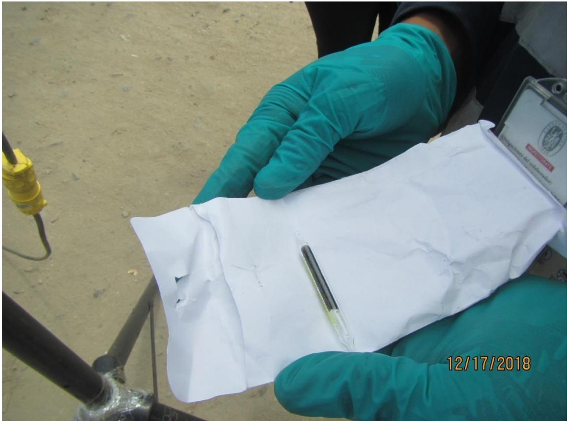
**FOTOGRAFÍA N° 03: TUBO ABSORBENTE DE CARBÓN
