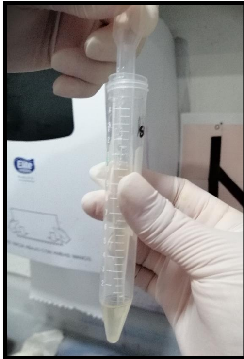
Imagen 5.- Retirando el sobrenadante con ayuda de una pipeta Pasteur y se dejó un volumen de 500uL
