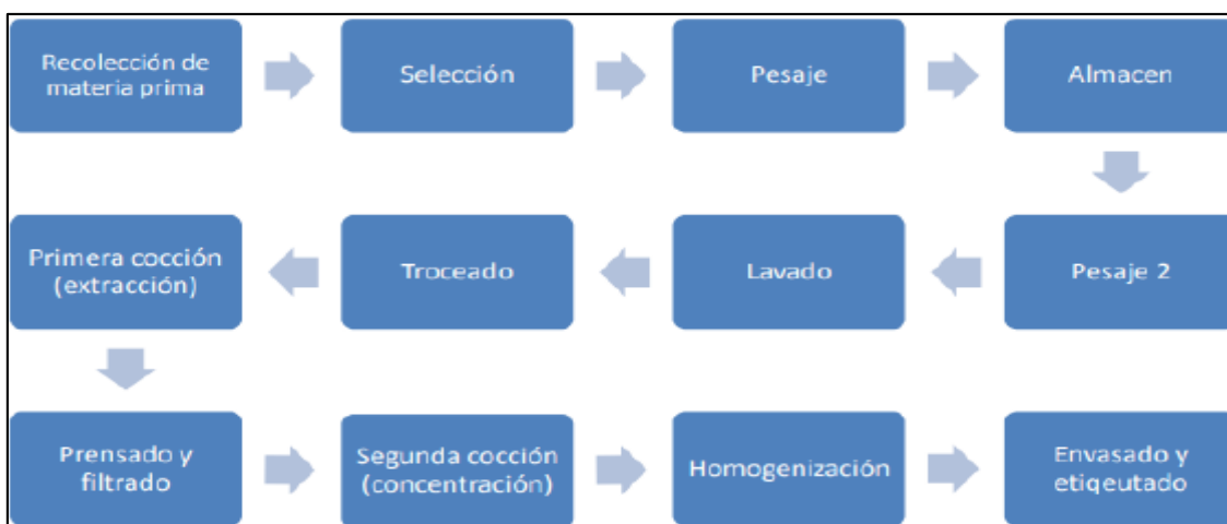
Figura 47. Proceso productivo del extracto de algarroba
