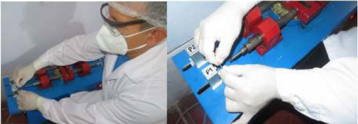
Fotografía N° 04 fuente propio: Montaje de los postes de fibra de vidrio en la maquina fatigadora de carga cíclica lineal HTL certificate – 021.
