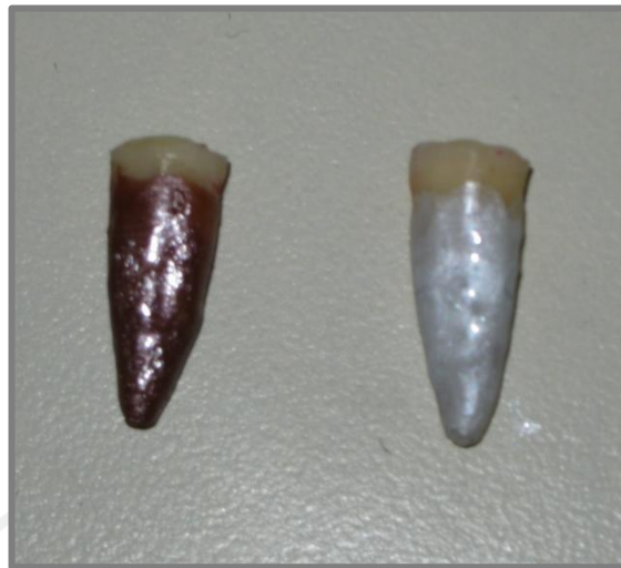
Imagen 18. Sección de las coronas clínicas 2 mm por encima de la unión amelocementaria y revestimiento de la parte radicular con esmalte de uñas.
