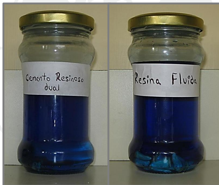
Imagen 19. Muestra sumergida por una semana en azul de metileno al 5 %.
