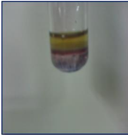
Figura 4. Identificación de formaldehído (formación de anillo violeta).
