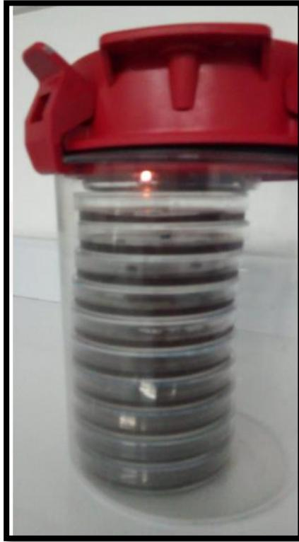
**Cuando el ambiente interno de jarra sea anaerobio y termina la combustión de la vela, se procede a incubar.**
