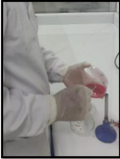
**Procedimiento de inoculación de 10ul de las sustancias de prueba (Extracto etanólico de propóleo al 30% y cloruro de cetilpiridinio al 0.05% más digluconato de clorhexidina al 0.05% y digluconato de clorhexidina al 0.12%) con micropipeta, en esterilidad, frente al mechero de bunsen**
