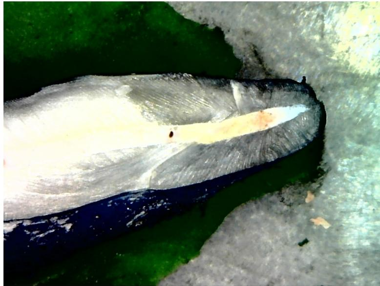
**Fotografía 14:** Corte transversal y vista del grado de microfiltración con microscopio digital de la pieza 4.4
