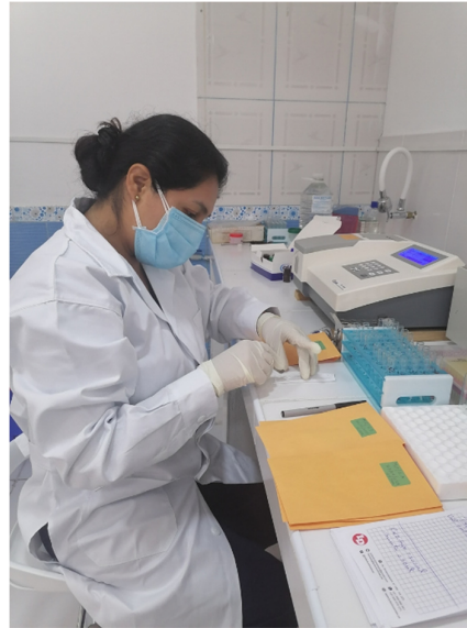
Figura 15. Realizando cortes de 1,0 cm de los soportes
