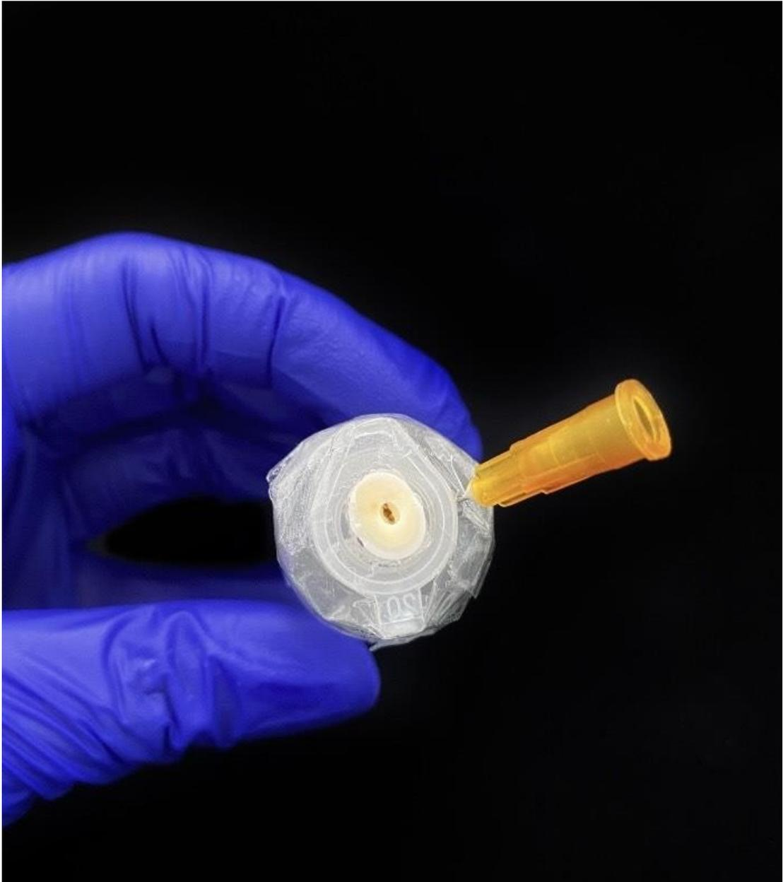
**Figura 14 - 15. Sellado de Vial de Vidrio con parafilm y la introducción de la aguja calibre 20G×1 ½.**
