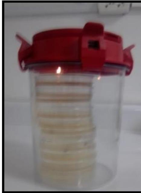
Incubación de las jarras de anaerobiosis en la incubadora de 37°C durante 24 y 48 horas
