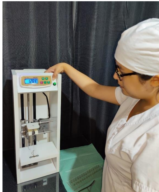
Realizando la medición de la fuerza de las cadenas elastoméricas.
