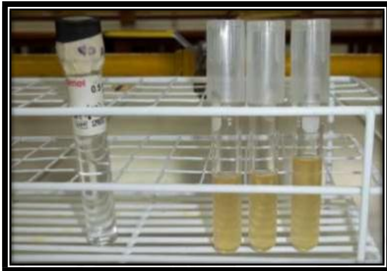
Enterococcus faecalis en caldo de infusión Trypticase soya (Escala de McFarland 0,5 ( 1,5 \times 10^8 bacterias / ml)).
