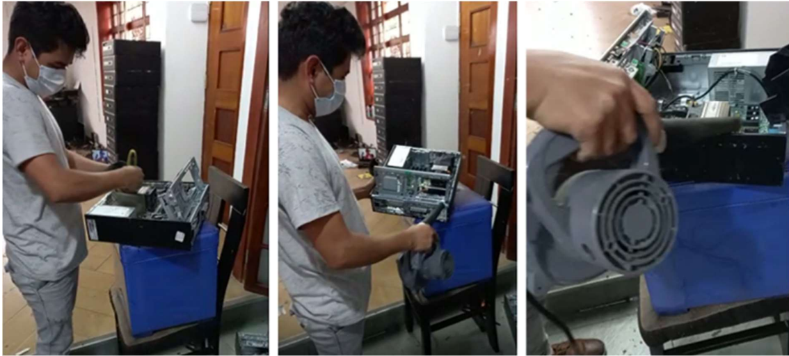
Figura 19 Pasos para realizar el mantenimiento preventivo.
