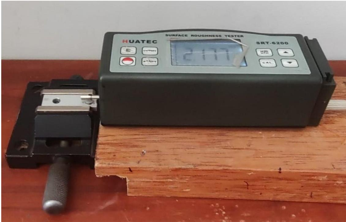
**valor de rugosidad superficial determinado por el Rugosimetro Digital (Huatec – SRT 6200)**
