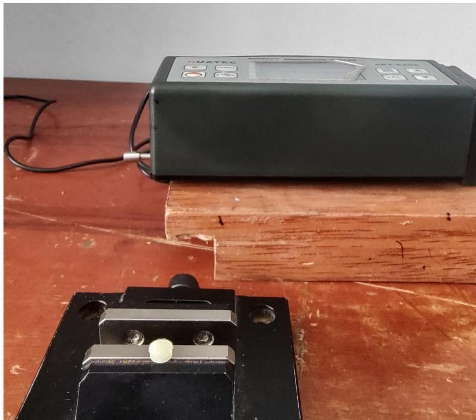
**Medida inicial de los cilindros de resina con el Rugosímetro Digital (Huatec – SRT 6200)**
