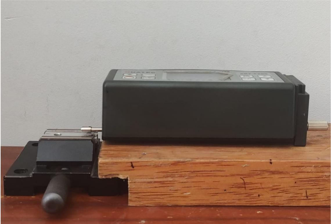
**Medida de rugosidad de los cilindros de resina después de 48 horas (muestras pulidas)**
