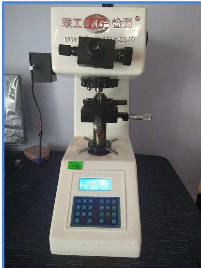
Anexo 4.9: Registro de punto máximo valor de microdureza mecánica superficial
