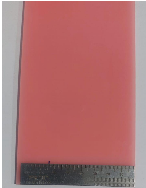
Obtención de las barras de cera de 64 x 10 x 2.5 mm
