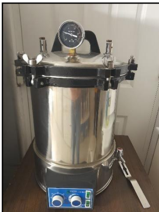
Figura 18. Autoclave para el uso en la prueba microbiológica
