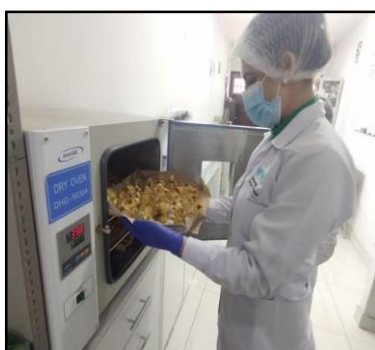
Figura 7. Procedimiento de secado de la muestra
