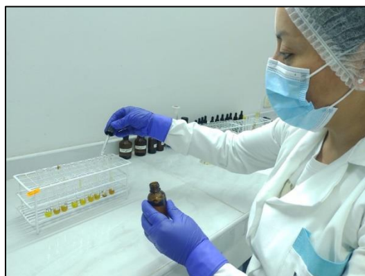
Figura 13. Añadiendo extracto seco al tubo de ensayo para prueba de solubilidad
